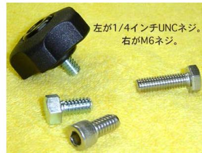
カメラネジは、1/4UNC-20 という規格品番です。六角ボルトか六角穴付ボルトを買い求めることができるので、三脚を使わずに実験装置に固定したり車載で使う際にはこのネジを用います。カメラネジの他にユーティリティネジ（インチネジ）がもうけられていますので、必要に応じてカメラプレートなどを別途製作します。
