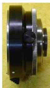
学術用では、ニコン F マウントレンズが性能が良いためによく使われます。その際は C マウント変換アダプタ (F-C マウント) を使います。左の写真が、ニッコールレンズと C マウント変換アダプタです。
